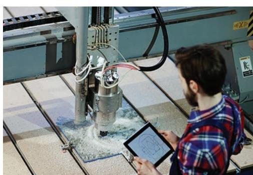
Сверление, зенковка и фрезеровка стекла осуществляются на современном высокоточном оборудовании с ЧПУ, которое также позволяет создавать сложные фигуры и формы по индивидуальному заказу.
