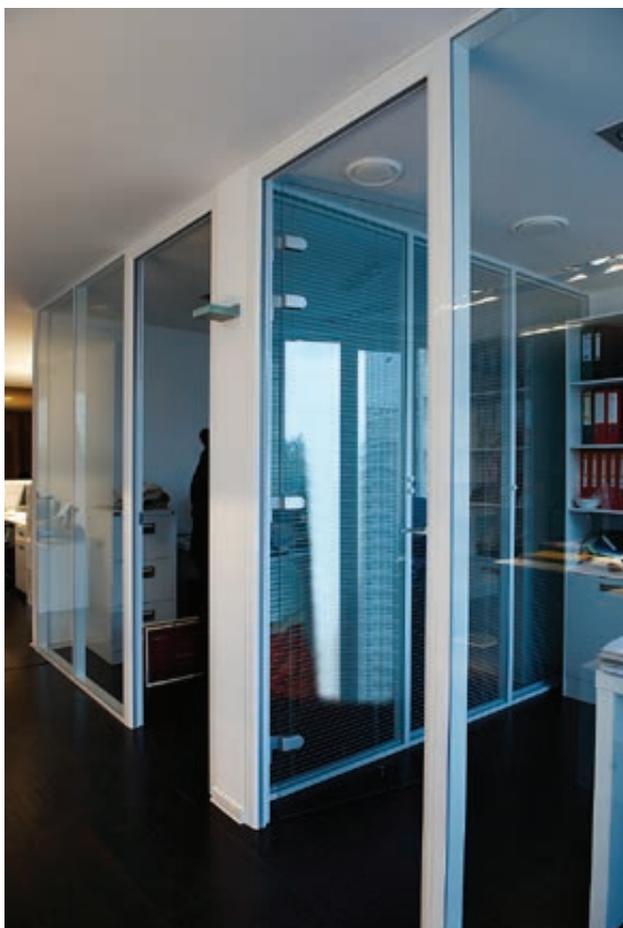
Возведение стеклянных перегородок в офисных помещениях не требует больших временных и финансовых затрат. При изготовлении, как правило, используется каленое стекло, которое отличается повышенной прочностью и стойкостью перед серьезными нагрузками. Доступны различные виды стекла и технологии его обработки. Допускается применение матовых и тонирующих декоративных пленок.
