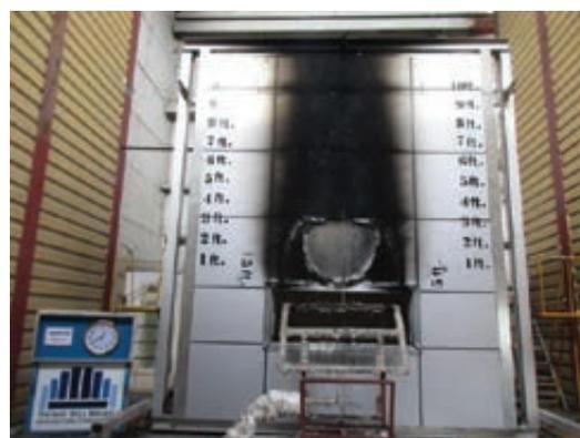
Испытательный образец через 10 минут в конце испытания на огнестойкость
